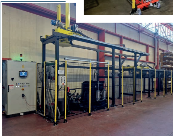
Impianto con tre stazioni di scarico
