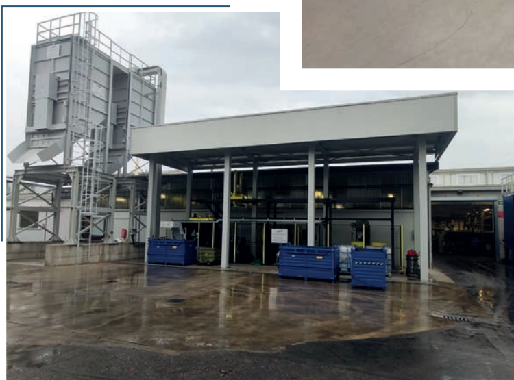
Impianto dotato di centrifuga per alluminio e ottone con sistema di insilaggio
